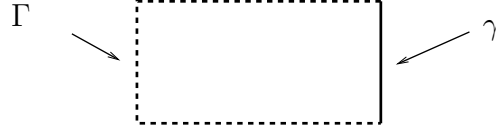
FIG. 1 – Domaine \Omega , avec subdivision de la frontière \partial\Omega en \Gamma (pointillé) et \gamma (trait plein).
