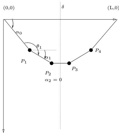
Figure 3: Modélisation de la poutre et de son chargement
