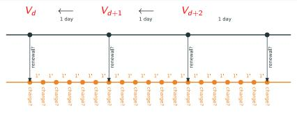
Fast time scale: minute (battery charge) Slow time scale: day (battery renewal)
