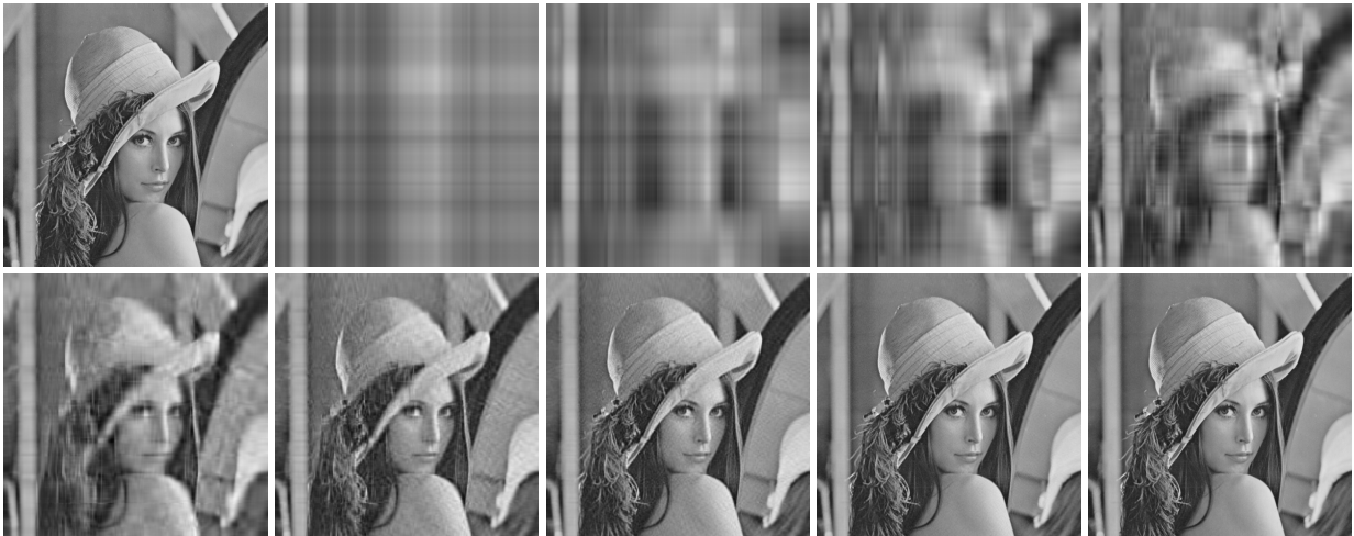
FIGURE 4.3: Exemple de compression d'image utilisant la décomposition en valeurs singulières. L'image numérique originale, ici une version en niveau de gris de la fameuse Lenna 29 (ou Lena ), à la gauche de la première ligne est constituée de 512 par 512 pixels (abréviation de la locution anglaise picture elements ) et est représentée en machine par une matrice carrée d'ordre 512 contenant des entiers codant la luminosité de chaque pixel (les valeurs de ces entiers sont ici comprises entre 0, pour le noir, et 255, pour le blanc). Les images suivantes correspondent à la meilleure approximation (au sens de la norme de Frobenius ou de la norme spectrale) de la matrice d'origine par une matrice de rang respectivement égal à (de gauche à droite) 1, 2, 4 et 8 pour la première ligne et 16, 32, 64, 128 et 256 pour la seconde ; elles ont été obtenues grâce à une décomposition en valeurs singulières de la matrice originale.
